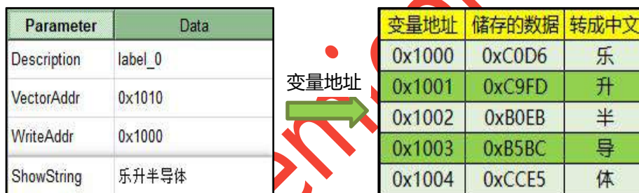
图 7-1: 变量地址内数据的储存方式
